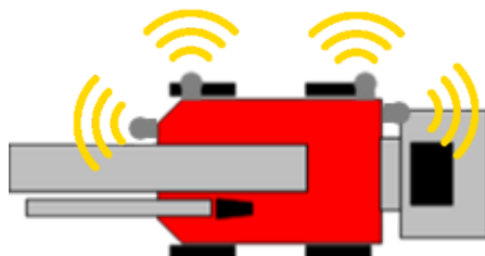
Figur 9 schematisk översikt över radarsensorernas positioner
